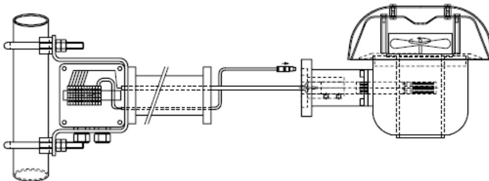
5.3 Verbinden Sie die Steckverbinder des Fühlers und des Montagearms.
